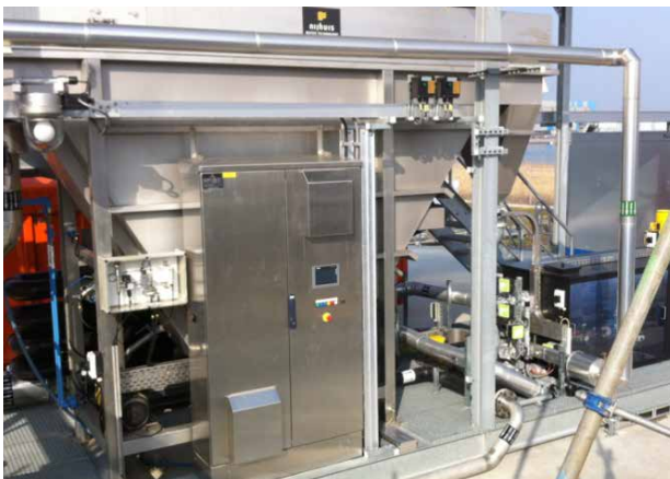
De DAF unit maakt een duurzame toepassing van afvalslib mogelijk
